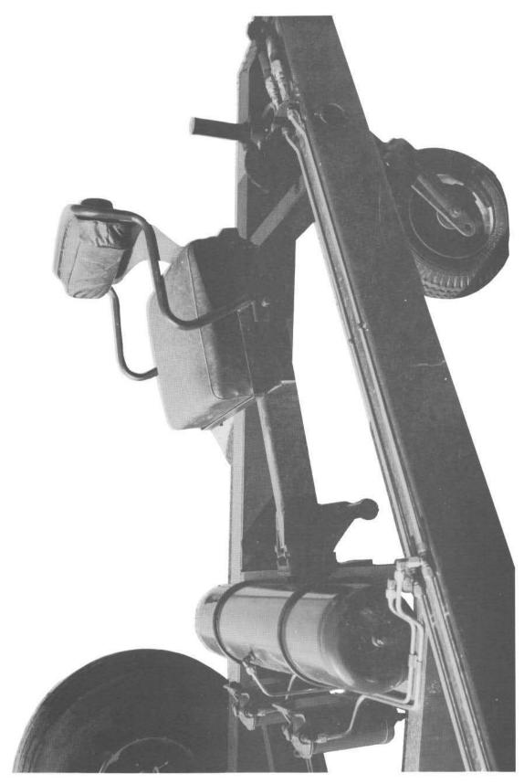
FIG. 54. INSTALLING OPERATOR'S SEAT ON DRAWBAR
